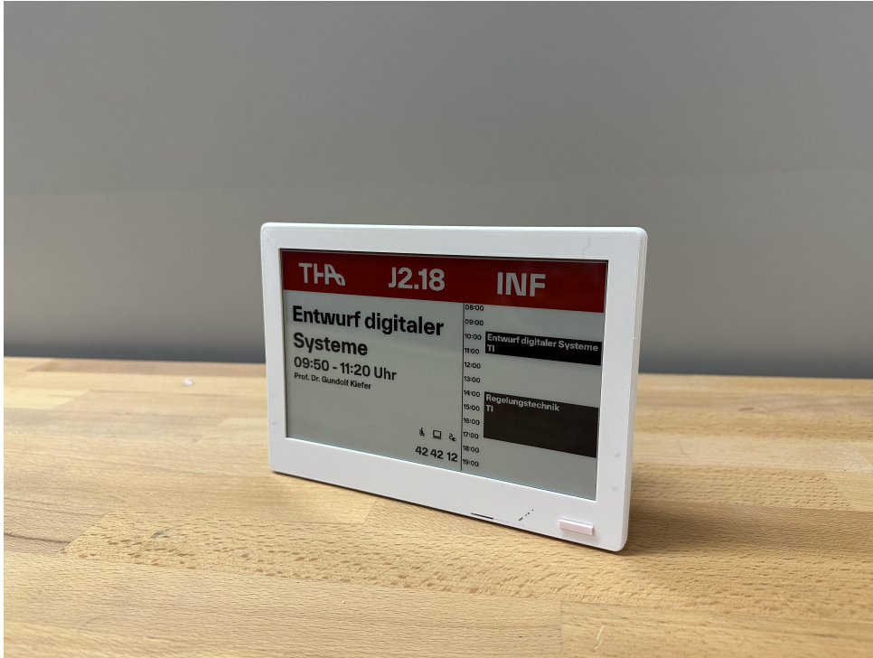
Abbildung 6.30: Das finale Prototyp-Gehäuse des 7.3-Zoll-Gehäuses.
