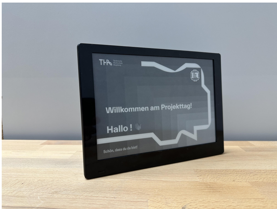
Abbildung 6.29: Das finale Prototyp-Gehäuse des 9.7-Zoll-Gehäuses.
